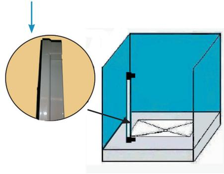
Entfernen Sie den Klebeschutz von der vertikalen Verschlussleiste und befestigen Sie sie an der Wand.
