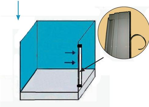
Positionieren Sie die vertikale Verschlussleiste wie im Kreis dargestellt, mit dem L-förmigen Teil nach außen zeigend.
