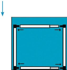
Setzen Sie gleichzeitig die Führungsschiene und das Rad in die entsprechende Halterung ein.
