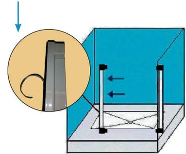
Ziehen Sie die Führungsschienen auseinander, bis sie in die Halterungen passen.
