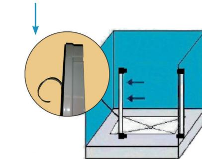
**4** Extender las guías hasta introducirlas en sus soportes.
