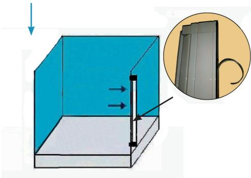
**2** Posicionar el perfil de cierre vertical tal y como indica la imagen del círculo, con la parte en forma de L hacia fuera.
